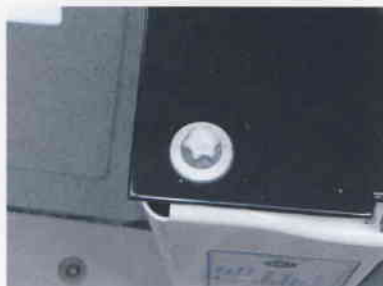
Bild 2: Montagepunkt für vordere zwei Bohrungen
